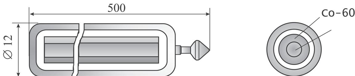
Рис. 3 Схема конструкции гамма-источника на основе  $\text{Co-60} + \text{Eu}_2\text{O}_3$  (вариант 3)
