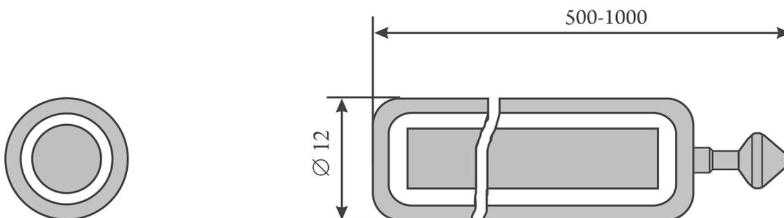
Рис. 2 Схема конструкции гамма-источника на основе отработавших поглощающих элементов с оксидом европия (вариант 2)
