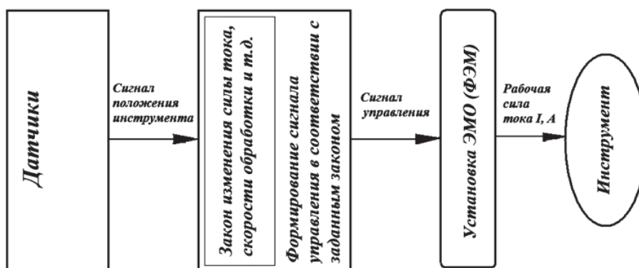
Автоматизированная система с закономерным изменением силы тока при ЭМО (ФЭМ)
