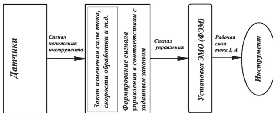
*Автоматизированная система с закономерным изменением силы тока при ЭМО (ФЭМ)*
