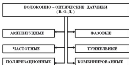
Рис. 2. Общая классификация волоконно-оптических датчиков
