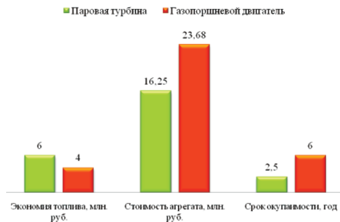
Рис. 4. Сопоставление паровой турбины АВПР-1.0М и газопоршневого двигателя Cummins C1400 D5
