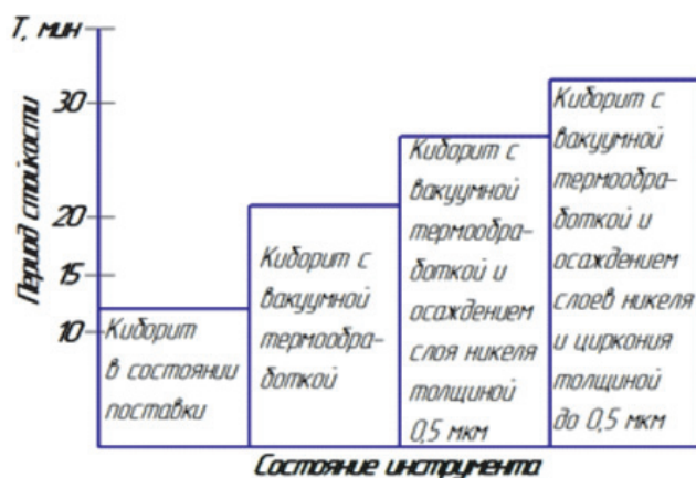
Рис. 4. Сравнительная стойкость пластины киборит в состоянии поставки и после различных этапов упрочнения пластины
