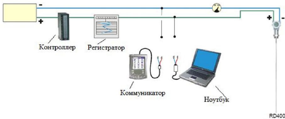
Рис. 2. Принципиальная схема соединения уровнемера RD-400 с измерительными и управляющими устройствами
