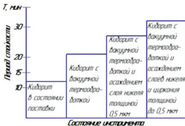
Рис. 4. Сравнительная стойкость пластины киборит в состоянии поставки и после различных этапов упрочнения пластины
