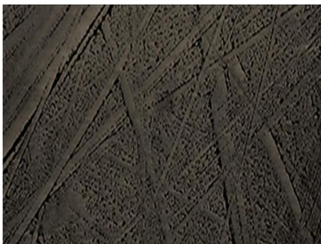
Рис. 1. Излом композитного базисного материала "Versyo". Увеличение ×750
