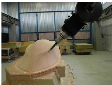
Рис. 2. Пятикоординатный портальный фрезерный станок MR 125, способен обрабатывать детали размером 15x5 м и высотой до 2,5 м
