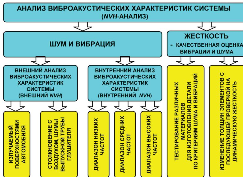
Рис. 1. Комплексный анализ виброакустических и прочностных характеристик автомобиля
