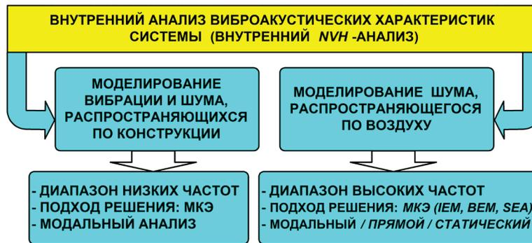
Рис. 4. Структура внутреннего комплексного виброакустического и прочностного анализа автомобиля
