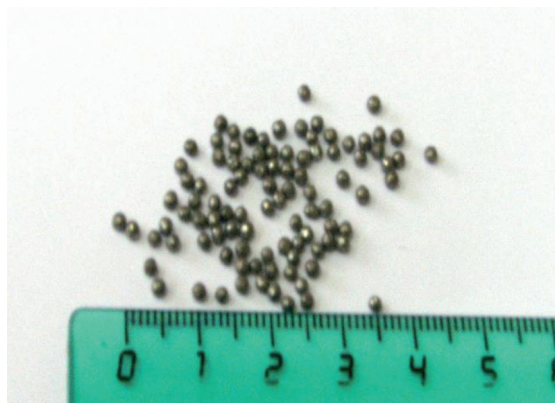
Рис. 1. Внешний вид цинка после обработки УДП в механоактиваторе
