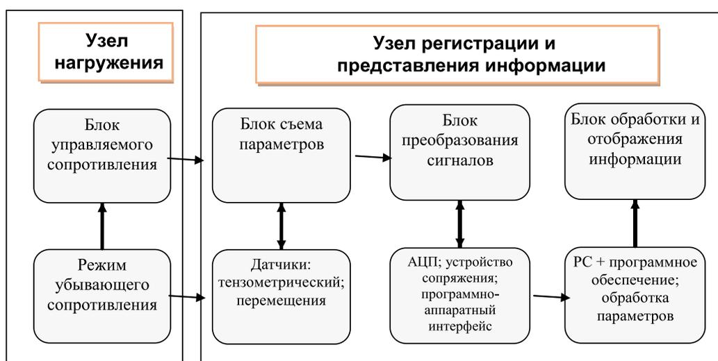
Рис.2. Блок-схема компьютеризованного тренировочно-исследовательского комплекса для копьеметателей
