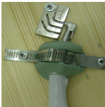
Рис.1. Фантом для изучения циклической нагрузки вращающихся Ni-Ti эндодонтических инструментов
