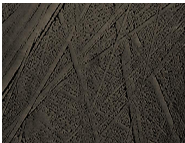
Рис. 1. Излом композитного базисного материала "Versyo". Увеличение ×750
