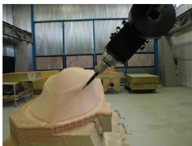
Рис. 2. Пятикоординатный портальный фрезерный станок MR 125, способен обрабатывать детали размером 15х5 м и высотой до 2,5 м
