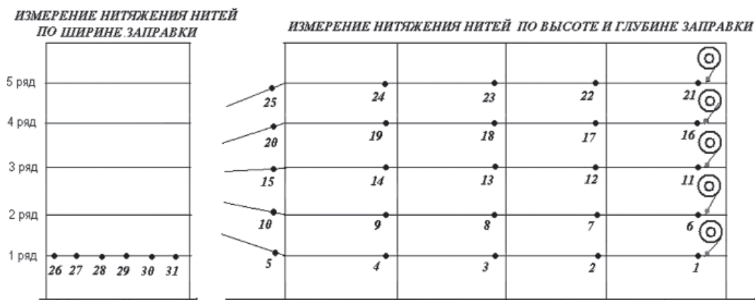
Рис. 1. Точки на рамке сновальной машины фирмы «Карл Майер», в которых проводились измерения натяжения нитей основы линейной плотностью 29 текс
