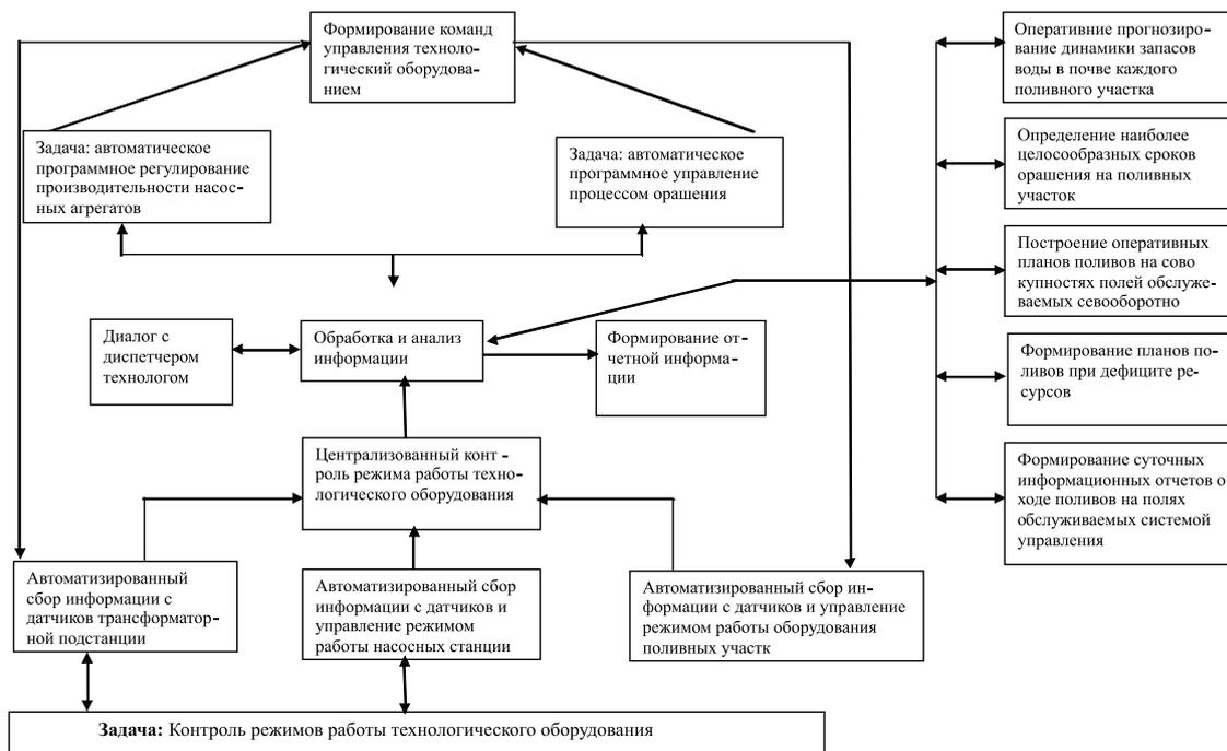
Рис. 2. Структурная схема комплекса задач АСУ ТП орошения
