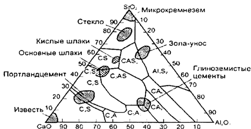
Рис. 1. Система \text{CaO}-\text{SiO}_2-\text{Al}_2\text{O}_3 (диаграмма Ранкина)
