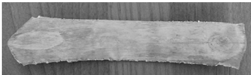
Рис. 3. Образец после четвертого цикла ARB-прокатки, количество слоев равное 16
