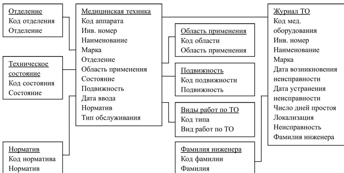
Рис. 1. Схема взаимосвязи таблиц в электронном реестре медицинского оборудования
