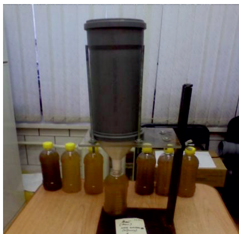
Рис. 2. Схема а) и фото б) фильтрационной установки для изучения водопроницаемости почвы и получения почвенных фильтратов на разных стадиях процесса становления фильтрации
