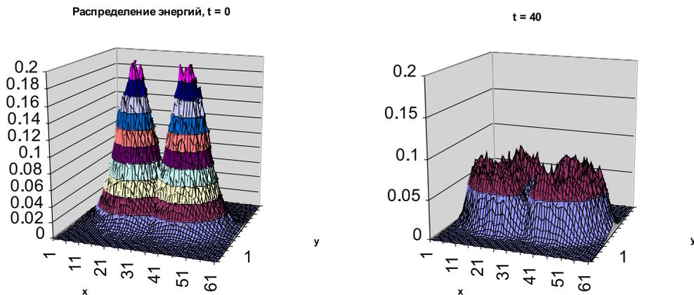
Рис. 6. Распределение удельной энергии при интерференции двух пятен [9–11]
