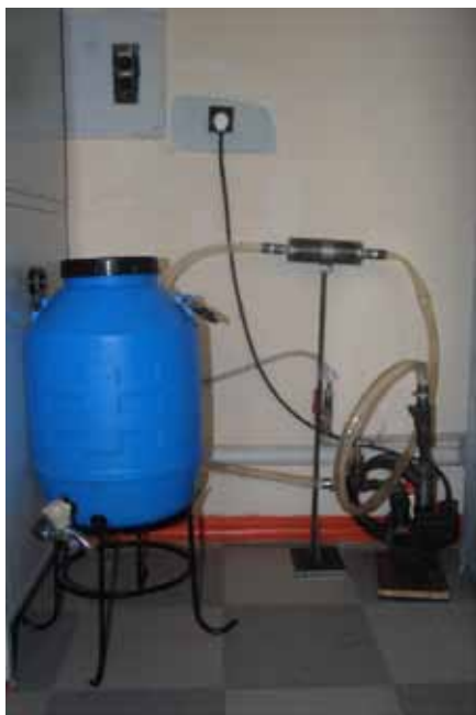
Рис. 1. Циркуляционная установка для определения количества железа, уходящего с металлической поверхности трубки
