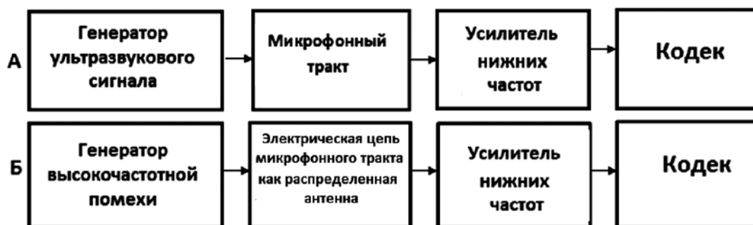
Рис. 1. Функциональная схема реализации: а – ультразвукового способа подавления и б – электромагнитного способа подавления диктофонов
