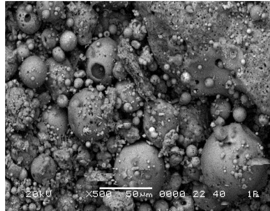
Рис. 3. Микрофотографии частиц золошлакового отхода
