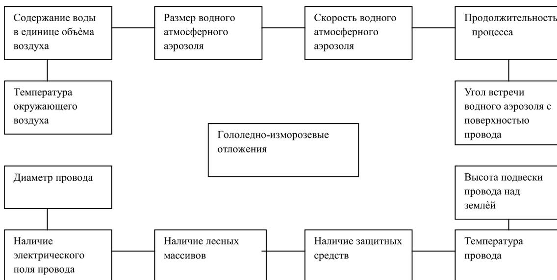
Рис. 1. Структурная схема факторов, действующих на гололедно-изморозевые отложения
