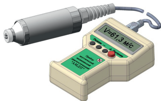
Рис. 2. Внешний вид прибора АМДП с указанием значения скорости, измеренной на эталонном силиконовом образце
