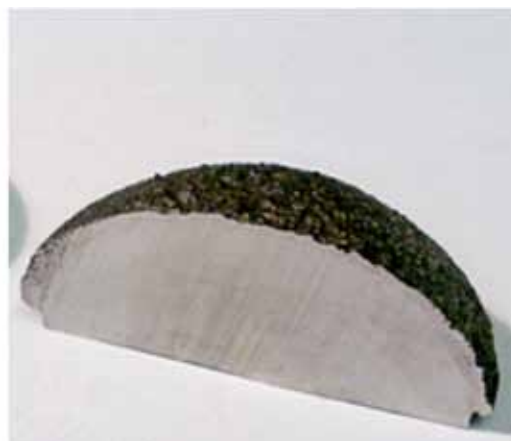
Рис. 3. Внешний вид монолитной титановой заготовки до ИПС и после ИПС, с нанесенным пористым слоем (а); также разрез заготовки после ИПС (б)
