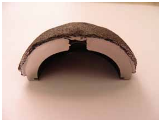
Рис. 4. Разрез заготовки на основе детали эндопротеза после припекания пористого слоя методом ИПС
