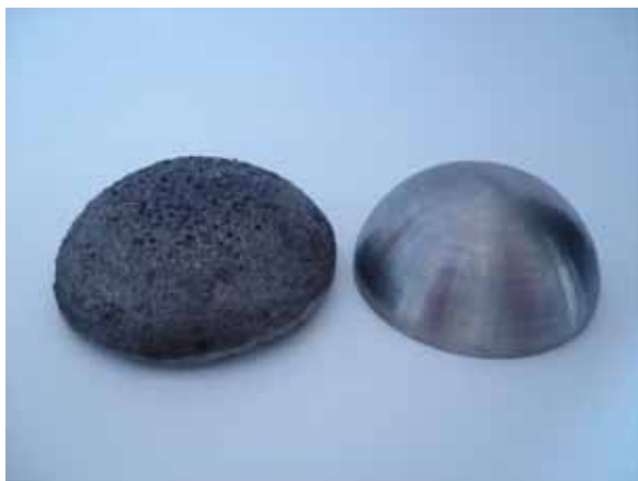
Рис. 3. Внешний вид монолитной титановой заготовки до ИПС и после ИПС, с нанесенным пористым слоем (а); также разрез заготовки после ИПС (б)
