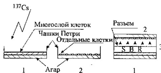
Рис. 1. Биосборка индуктора и детектора ВБИ. 1 – индуктор ВБИ, 2 – детектор ВБИ, 3 – биосборка ВБИ (SBR secondary biogenic radiation)
