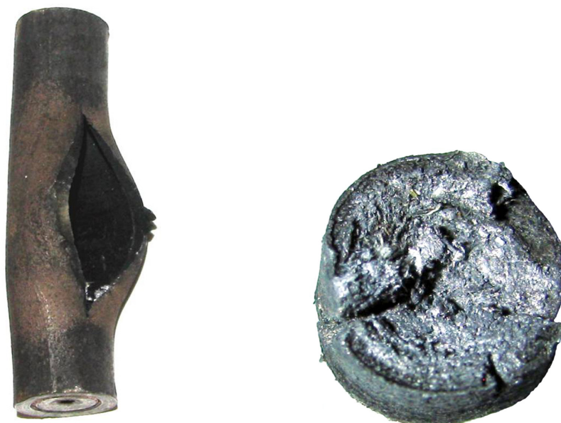
Рис. 3. Ампула и сохранившийся в верхней части ампулы слой наполнителя после взрывного нагружения
