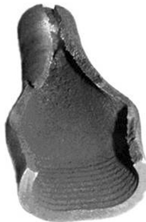
Рис. 1. Ампула после процесса взрывного нагружения
