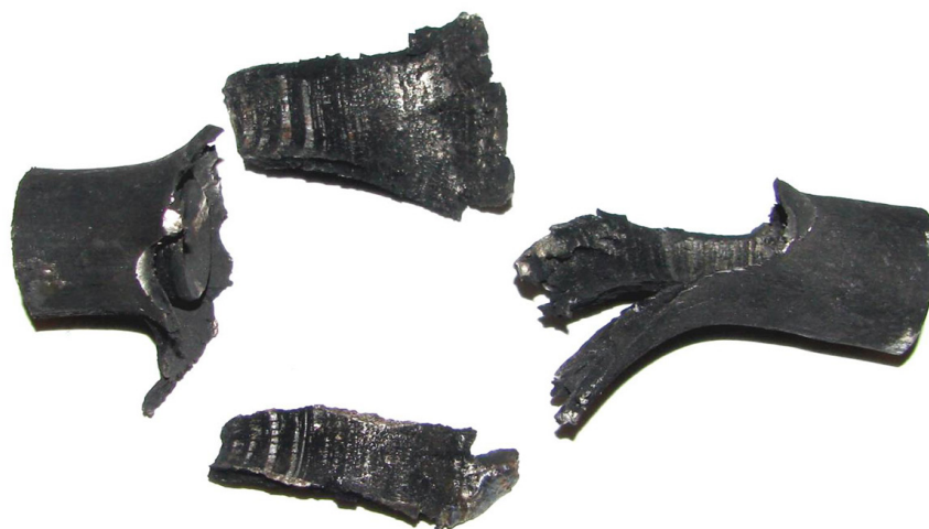
Рис. 2. Фрагменты ампулы после взрывного нагружения
