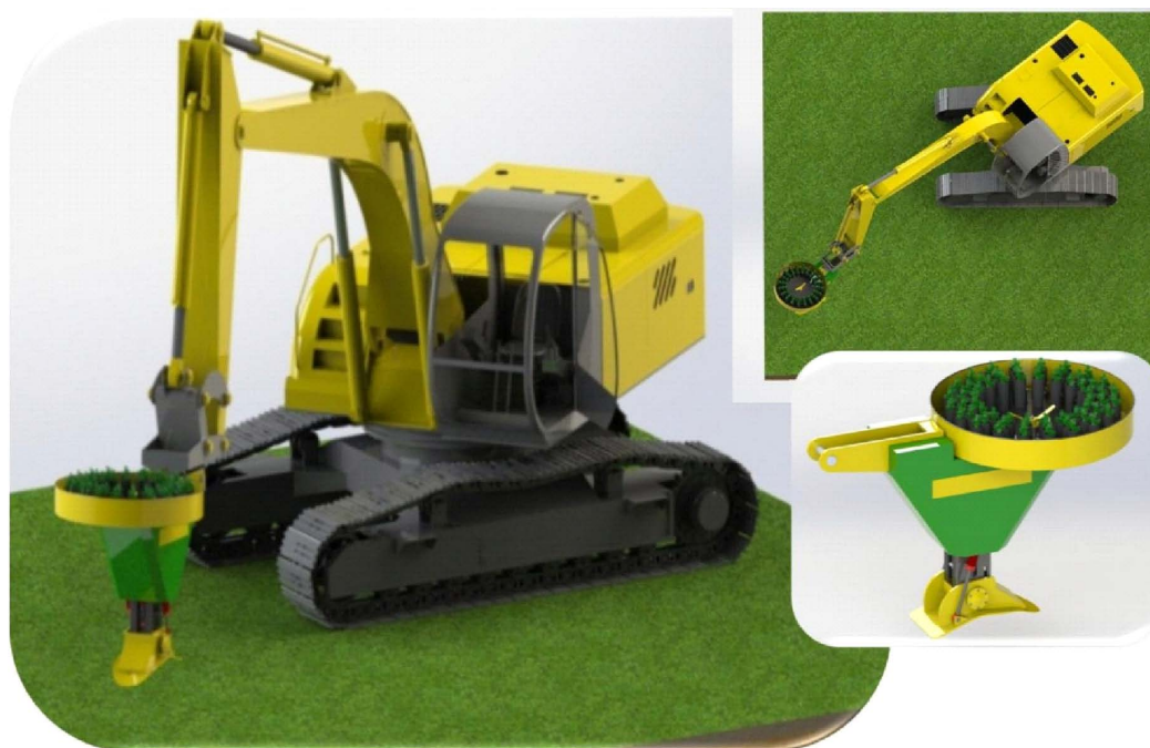
Рис. 5. Модель автоматизированного посадочного агрегата подвергнутая рендерингу
