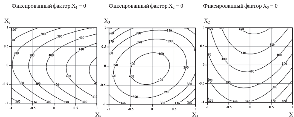
Рис. 1 Сечения поверхностей отклика влияния технологических параметров выработки петельной ткани на её воздухопроницаемость
