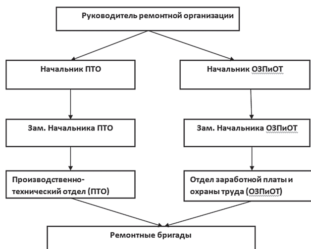
Рис.4. Структурная схема организации управления ремонтным предприятием
