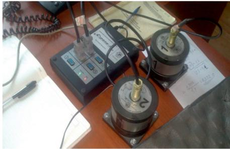
Рис. 3. Приборный комплекс для динамических испытаний человека
