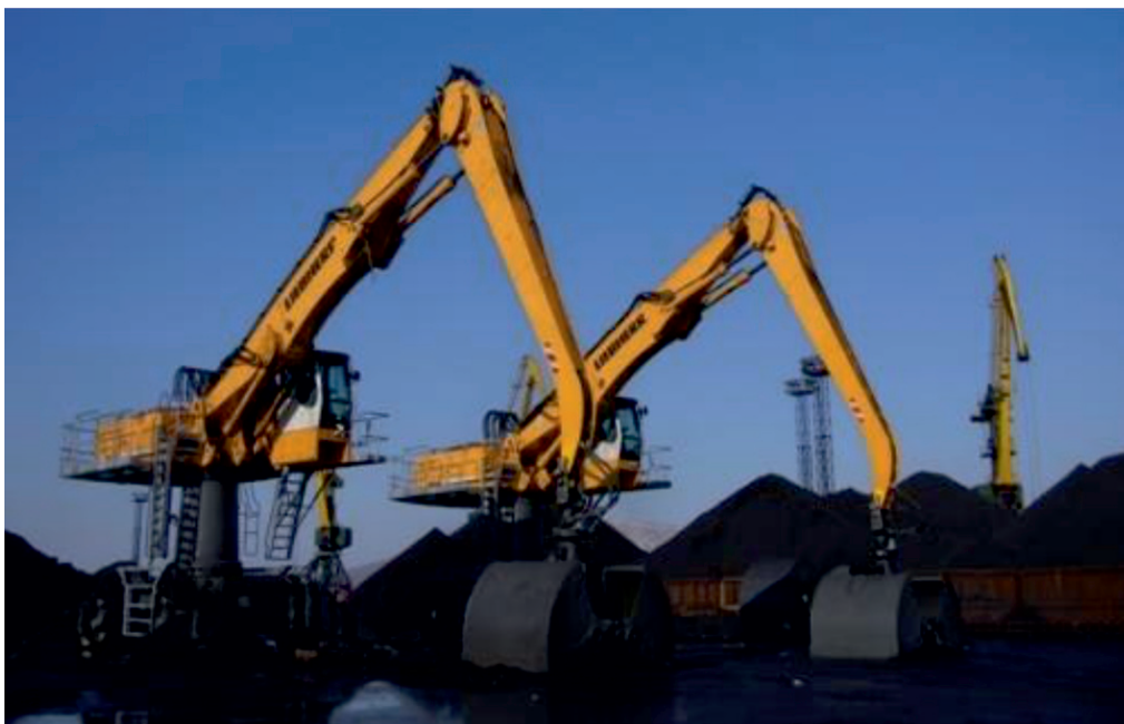
Перевалка угля грейферным способом на одном из угольных терминалов и открытый вид складирования приводят к загрязнению угольной пылью атмосферы и морской среды
