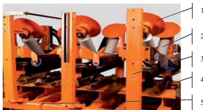
Рис. 2. Вид линейных секций поезда для камерной выемки: 1 – удерживающие диски; 2 – опорные катки рабочей и холостой ветви; 3 – линейная секция; 4 – гусенично-скребковые опоры передвижения; 5 – подвижное соединение линейных секций поезда
