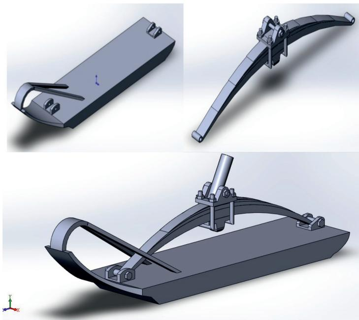
Рис. 3. Результаты моделирования подвески рулевой лыжи снегохода
