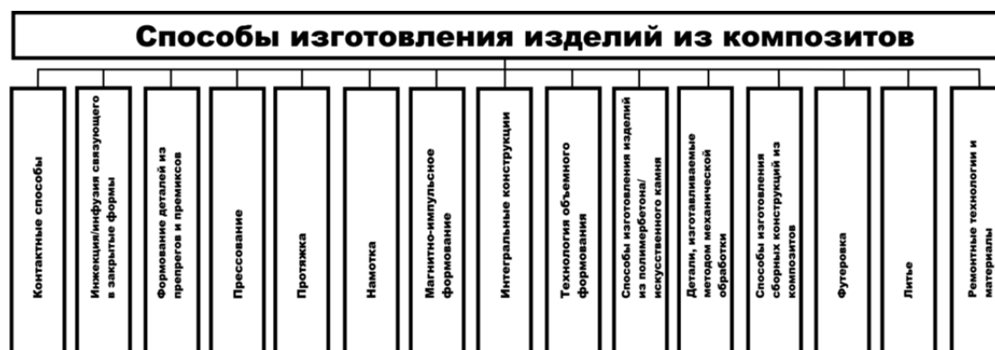
Рис. 1. Основные способы получения изделий из ПКМ
