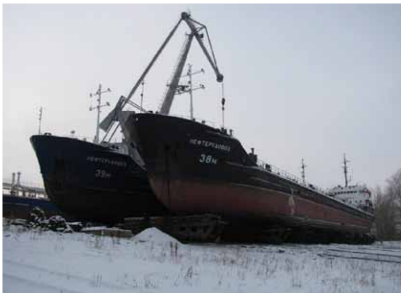
Рис. 4. Судна типа «нефтерудовоз», предлагаемые авторами под переоборудование в специальные многоцелевые саморазгружающиеся суда (МЦС)
