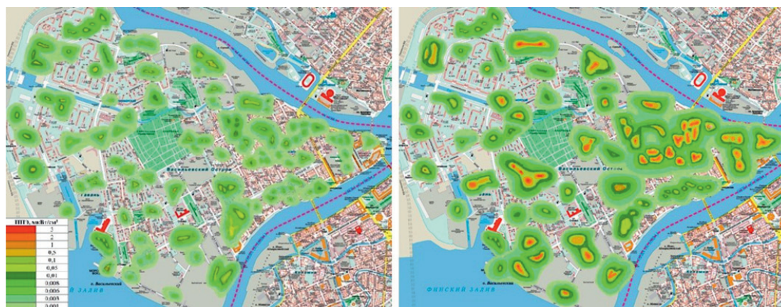
Распределение плотности потока энергии электромагнитного поля на территории Василеостровского района на высоте 2 м (слева) и 15 м (справа)
