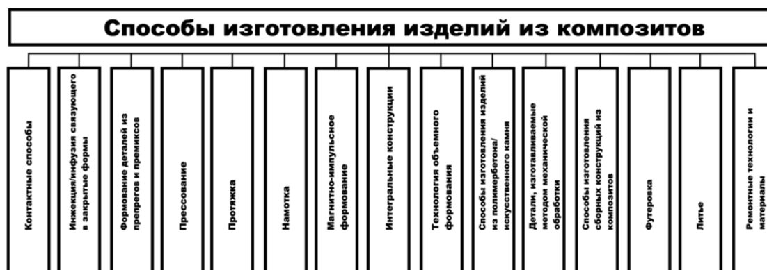
Рис. 1. Основные способы получения изделий из ПКМ
