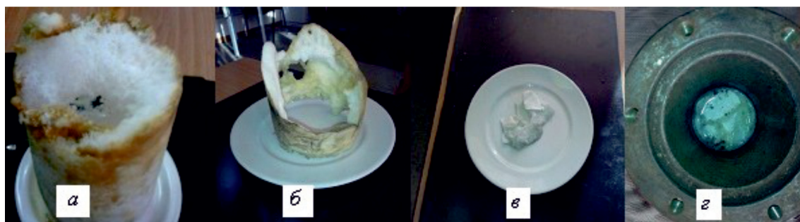
Рис. 1. Фотографии гидратов, полученных: а – из воды; из раствора хлорида кальция с концентрациями: б – 5%; в – 10%; г – 15 %
