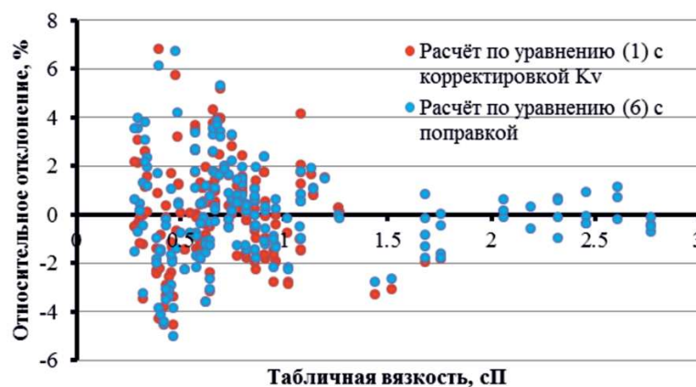
Рис. 12. Величина относительного отклонения расчётной вязкости от её табличного значения при корректировке коэффициента K_v и поправки Хагенбаха по числу Re
