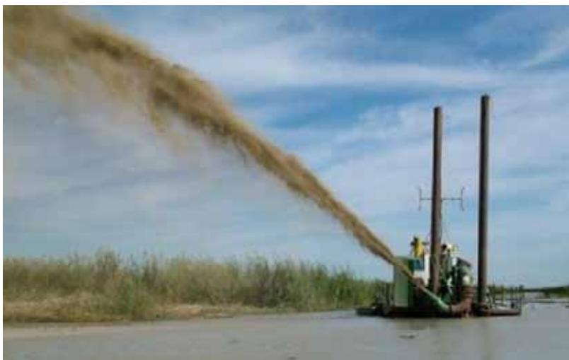
*Рис. 1. Работающий земснаряд*
