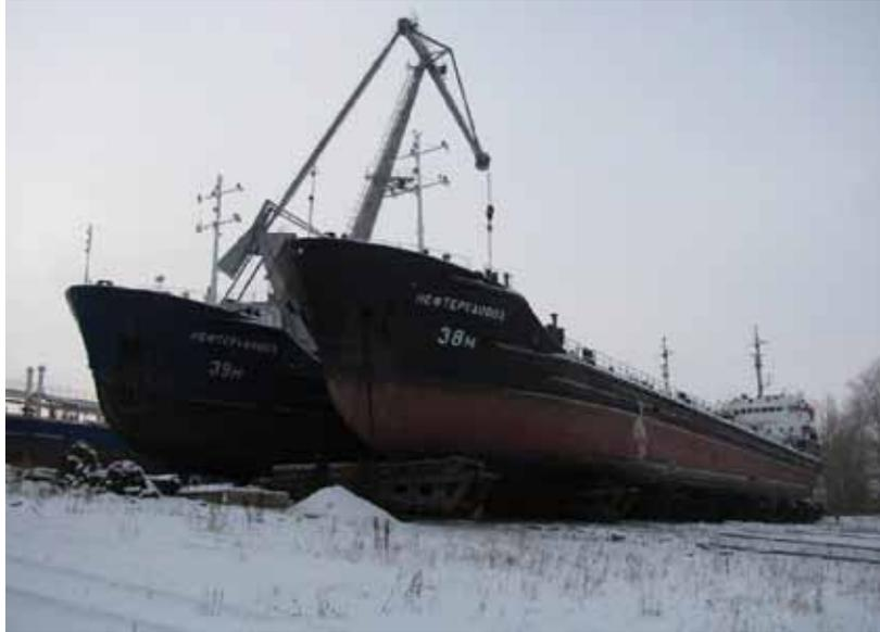
Рис. 4. Судна типа «нефтерудовоз», предлагаемые авторами под переоборудование в специальные многоцелевые саморазгружающиеся суда (МЦС)
