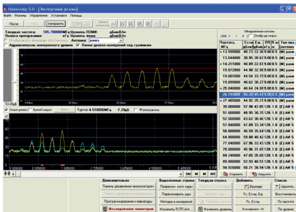
Рис. 6. Изображение с ПАК «Навигатор», на котором приведен список частот выделенных программой
