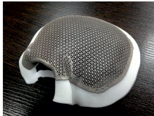
Рис. 5. Модель в виде фрагмента черепа с наложенным имплантатом
