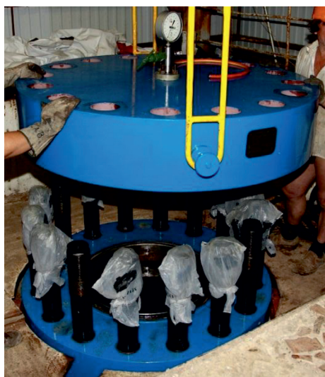
Рис. 5. Фланец тест-камеры со шпильками и крышка перед закрытием
