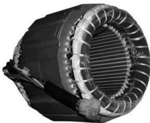
Рис. 5. Внешний вид распределенной обмотки статора
