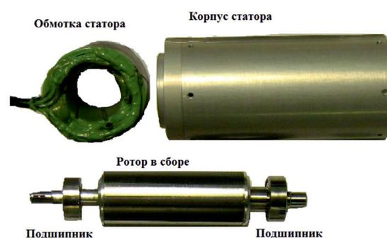
Рис. 1. Основные элементы конструкции электродвигателя с постоянными магнитами
