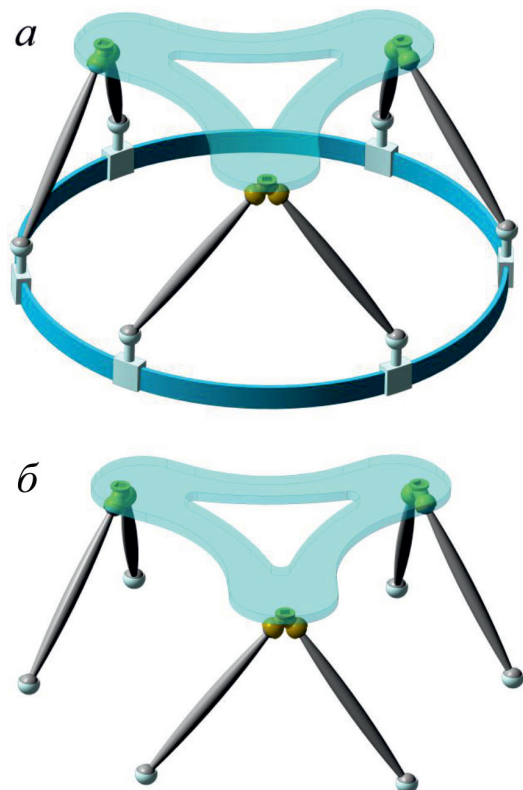
Рис. 3. Кинематическая схема ротопода (а); пространственная кинематическая цепь параллельной структуры (б)
