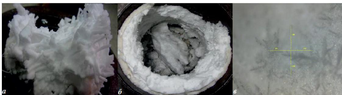
Рис. 4. Гидраты природного газа, полученные в растворах гидрокарбоната натрия: а) с концентрацией 0,25%; б) с концентрацией 2%; в) микрокристаллы
