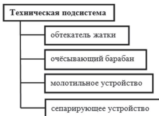
Рис. 2. Элементы технической подсистемы уборки сои очёсом
